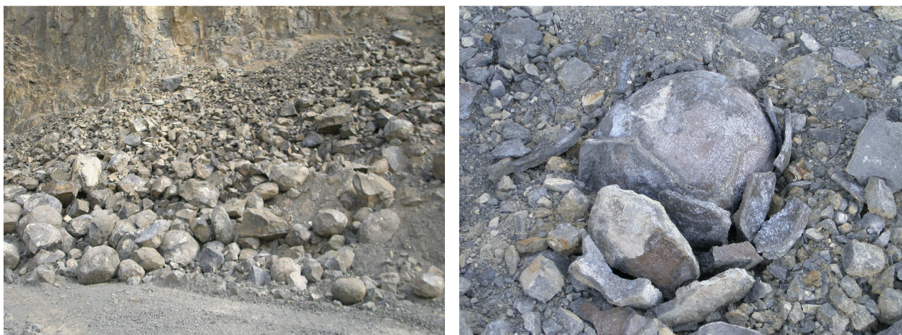
Obr. 2.6. Příklad kulovitého rozpadu bazaltů na lokalitě Dobkovičky (snímek vlevo) a Krásný Les (snímek vpravo).
