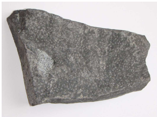
Obr. 2.7. „Sunburns“ vzorek čediče po zkoušce varem.
