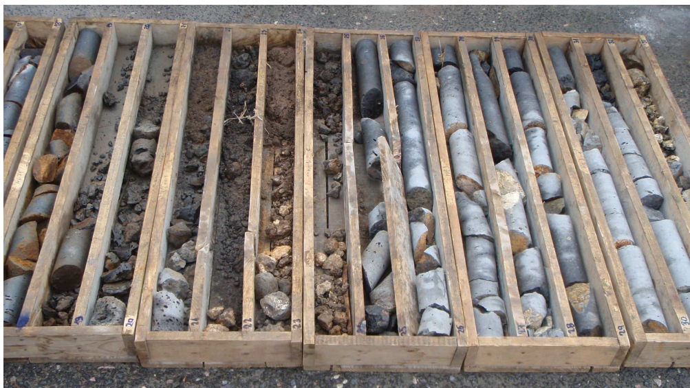
Obr. 2.8. Vrtná jádra profilem bazaltového masivu.
