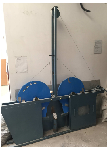
Obr. 2.3. Přístroje pro zkoušení technologických charakteristik kameniva: Bondův padostroj (snímek vlevo) a Bondův přístroj pro zkoušení abraze (snímek vpravo).
