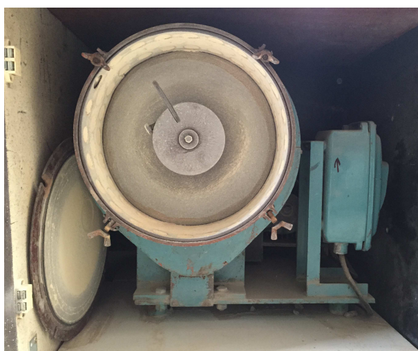
Obr. 2.3. Přístroje pro zkoušení technologických charakteristik kameniva: Bondův padostroj (snímek vlevo) a Bondův přístroj pro zkoušení abraze (snímek vpravo).
