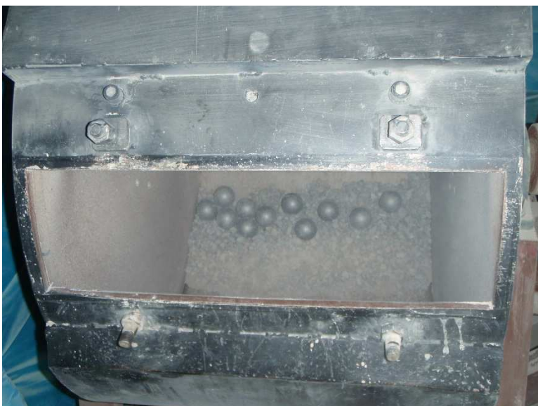
Obr. 4.7. Buben zařízení Los Angeles se vzorkem a koulemi po zkoušce.
