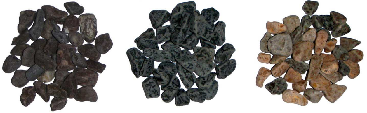
Obr. 4.11. Kamenivo po zkoušce obrusnosti pneumatikami s hroty.
