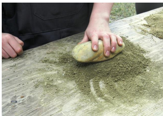
Obrázek 1. Rozmělnění hlíny kamenem
