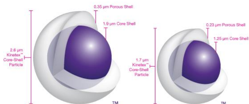
Obr. 4 – Povrchově porézní částice kolon Kinetex, Phenomenex [24]
