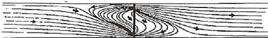
Obrázek 14: Cirkulační vrt v proudovém poli pro různé hodnoty objemové hustoty toku (Stamm, 1995).
