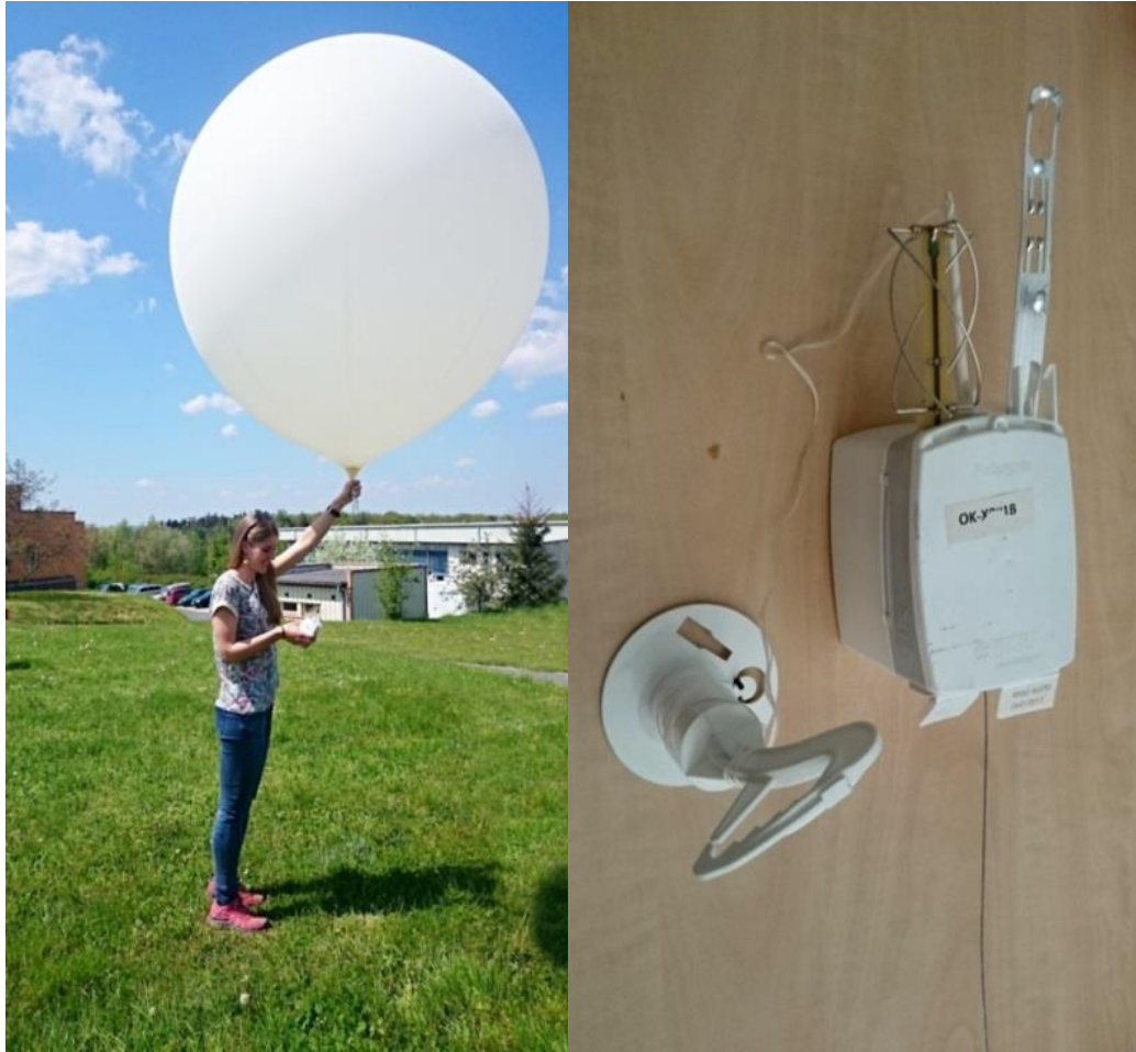
Obr. 8: Vodíkový balón a radiosonda VAISALA RS92-SGP.
