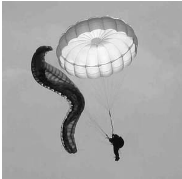
Obrázek 1 Funkční stav záložního padáku
