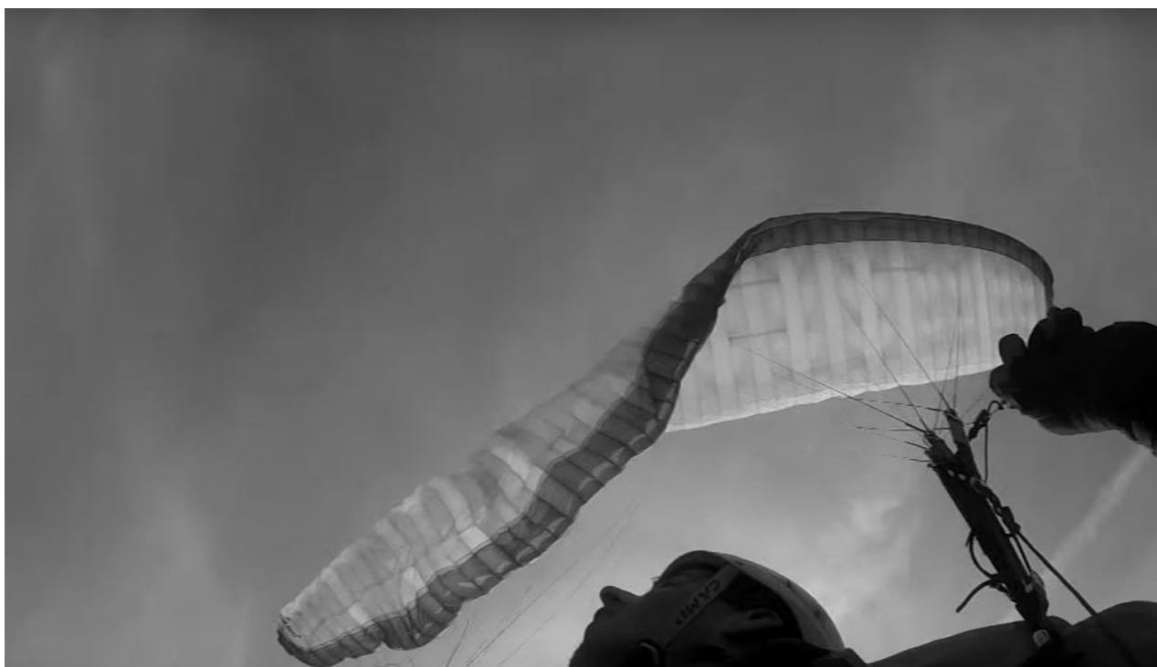
Obrázek 7 Asymetrické čelní zaklopení vrchlíku (autorský snímek)
