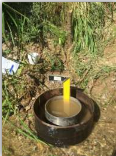
Obrázek 8: Infiltrační zkouška R6 na profilu PF2 v korytě řeky Jizery za použití dvojitého prstence.
