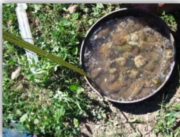
Obrázek 7: Infiltrační zkouška P12 na polní cestě blízko profilu PF3.
