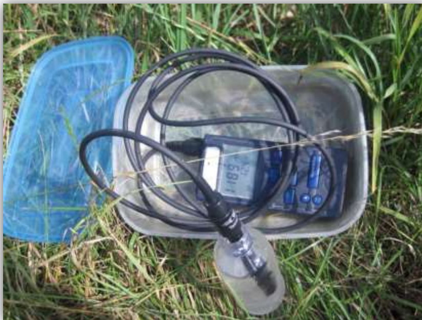
Obrázek 9: Měření konduktivity vzorku podzemní vody z vrtu V4.
