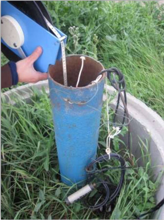
Obrázek 6: Měření hladiny podzemní vody na vrtu V8 elektro- kontaktním hladinoměrem.
