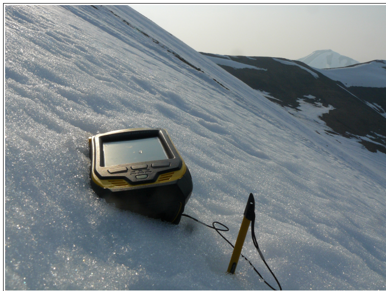
Obr. 17: DGPS přijímač při polohovém měření bodů na povrchu ledovce.
