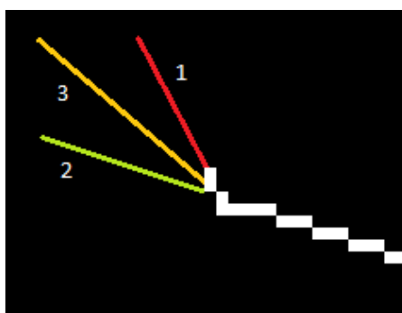
Obrázek 3.12: Rozdíly ve směnicích (1 - směrnice koncového bodu; 2 - očekávaná směrnice vzhledem k průběhu linie; 3 - průměr 1 a 2)
