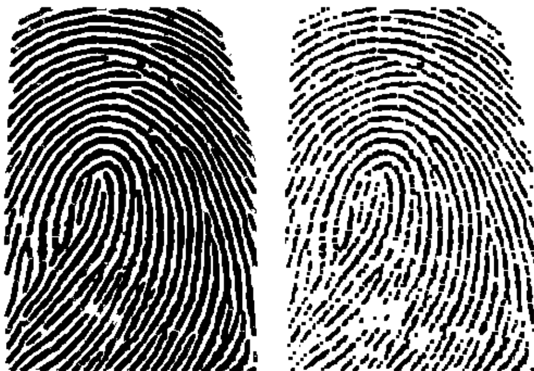
Obrázek 2.2: Výsledek binarizace transformacemi s vylepšením okrajů (vlevo) a bez vylepšení (vpravo).
