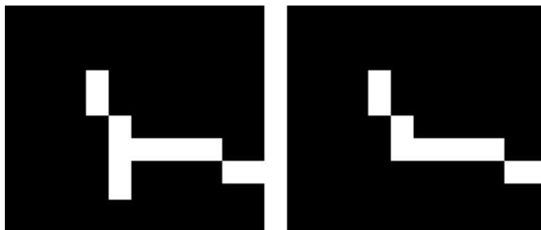
Obrázek 3.11: Zakončení linie před (vlevo) a po redukci krátkých větví (vpravo)
