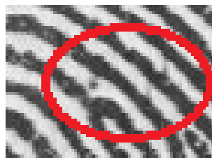
Obrázek 3.4: Chyby snímání (vyznačená oblast obsahuje nečistotu mezi liniemi a rozmazání)
