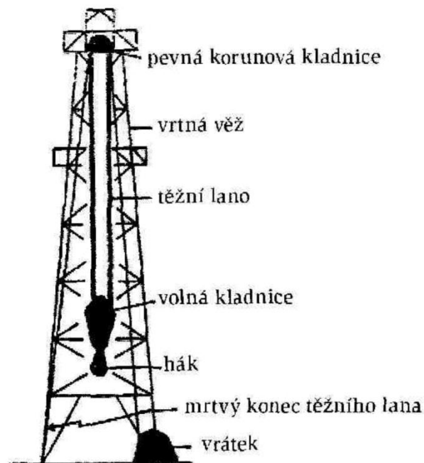
Obr. 5.1: Schématické znázornění vrtné věže s popisem hlavních částí Zdroj: Pinka et al., 2014a
