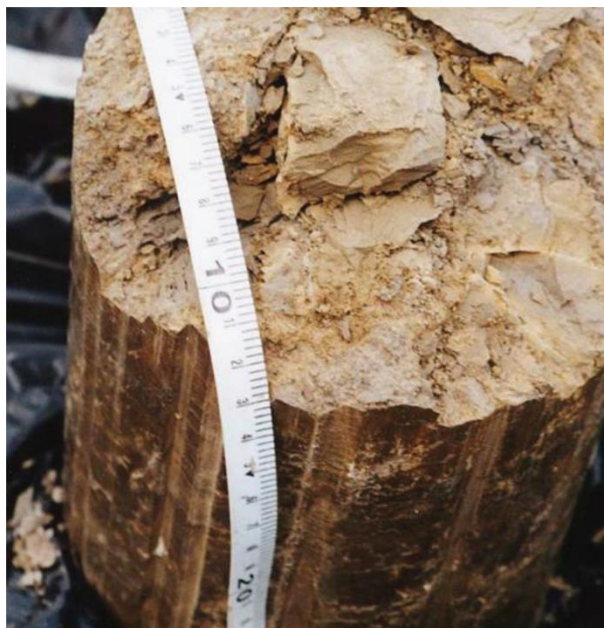
Obr. 6.1: Ukázka vrtného jádra křídového jílovce, kde je názorně vidět rozdíl ve vzhledu jádra uvnitř a na povrchu jádra
