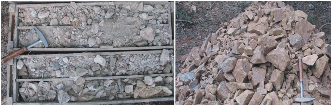
Obr. 6.3: Srovnání horniny kabrických pískovců, kde na jednom obrázku je vzorek horniny odebraného z jádrového vrtání na sucho (vlevo) a druhý vzorek té samé horniny vytěženého pomocí bagrování (vpravo)
