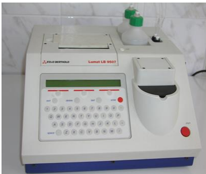
Obrázek 7. Luminometr Lumat LB 9507(29)
