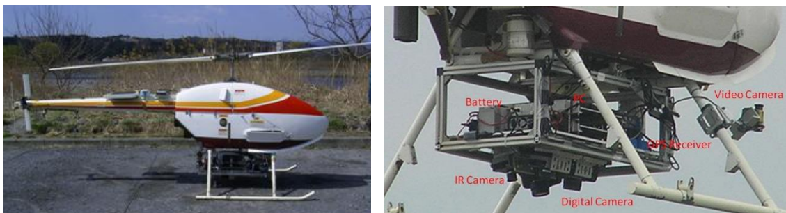
Obr. č. 5: Bezpilotná helikoptéra RPH2 a detail užitočného nákladu. Zdroj: Nagai, et al., (2013).
