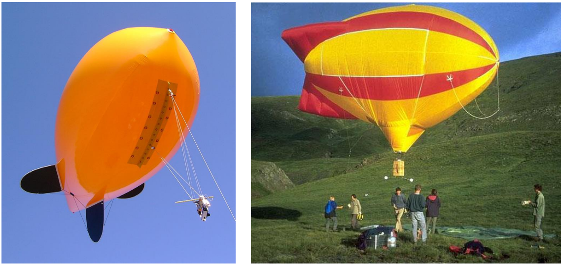
Obr. č. 1: Príklady nevystužených vzducholodí plnených héliom (vľavo) a teplým vzduchom (vpravo) použitých na fotogrametrické účely. Kamera je umiestnená na závesnom zariadení. Zdroj: Aber [online].
