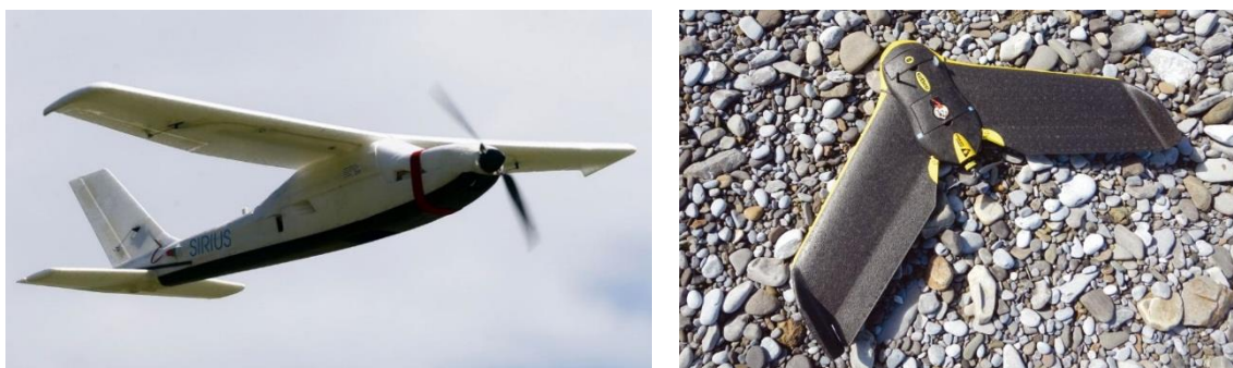
Obr. č. 4: UAV modely s pevným krídlom. Vľavo model Sirius I. (Zdroj: MaVinci SIRIUS UAS [online]), vpravo model eBee (Zdroj: Tamminga, et al. (2015b))
