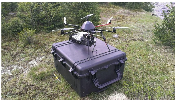
Obr. č. 6: Príklad hexakopteru od nemeckej spoločnosti MikroKopter. (vlastná tvorba)
