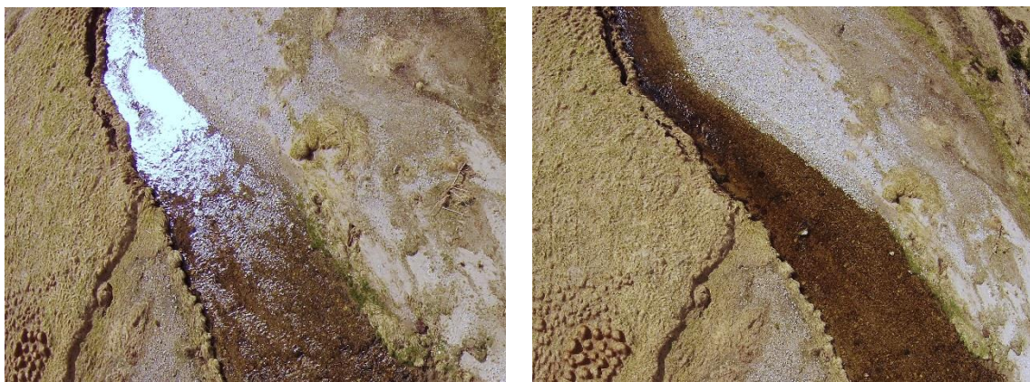
Obr. č. 11: Príklad UAV snímky nevhodnej na určovanie batymetrie vodného toku (vľavo) kvôli odrazom na hladine. Vpravo snímka toho istého úseku z iného uhla (dáta poskytol doc. Langhammer)
