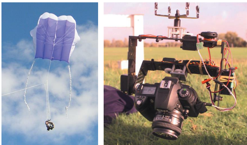
Obr. č. 2: Príklad šarkana (vľavo) a detail závesného systému (vpravo). Zdroj: Smith et al. (2009).
