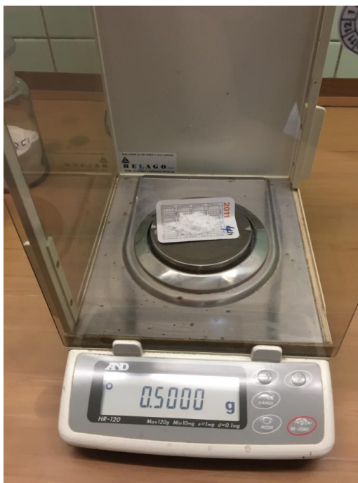
Obr. č. 13 Navážený vzorek na analytických vahách HR 120
