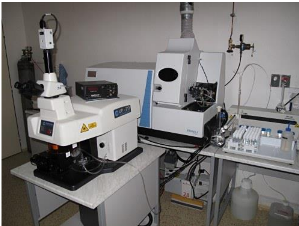
Obr. 6: Laserová sonda NewWave a hmotnostní spektrometr X Series II; zdroj: https://www.natur.cuni.cz/geologie/laboratore/laboratore-a-metody/laborator-plazmove-spektrometrie-laps-icp-ms-icp-oes/icp-ms-a-icp-ms-la-1/la-icp-ms ; 30. 4. 2016
