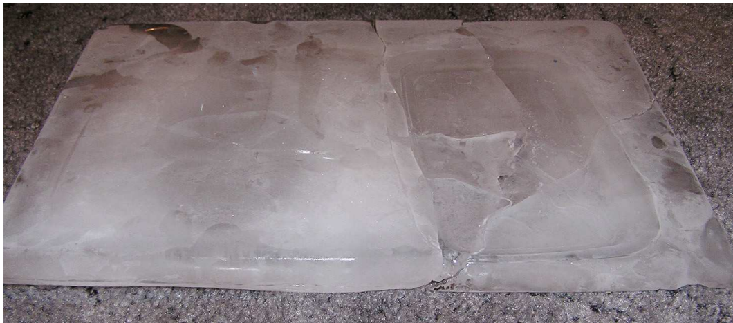
Obrázek 27: Vrstva ledu „po rekonstrukci“ – popraskala při odstraňování zamrzlé nádoby
