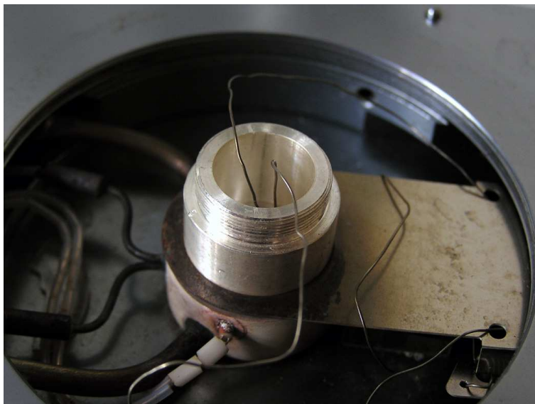
Obrázek 6: Detail pracovní komory aparatury se stříbrnou nádobkou
