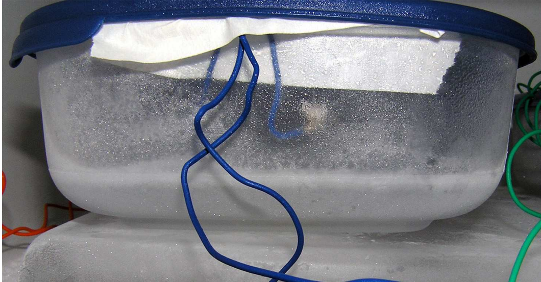
Obrázek 28: Nádoba se studenou vodou se do ledu neprotavila
