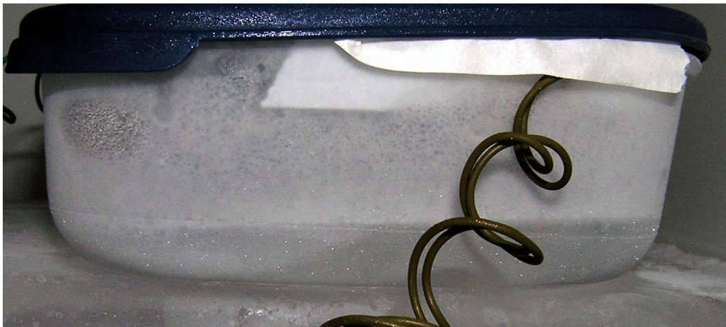
Obrázek 29: Nádoba s horkou vodou se do ledu protavila
