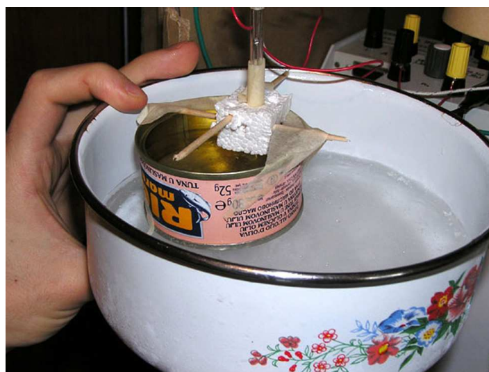
Obrázek 23: První experiment s ledovou vrstvou – nádoba s původně studenou vodou se „protavila“ jen do hloubky okolo 1 mm
