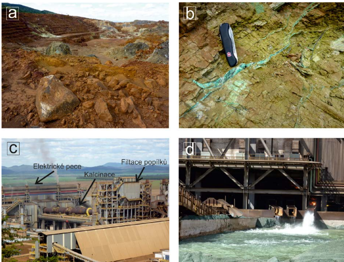
Obrázek 7. Těžba Ni lateritů a metalurgie Ni v Barro Alto (Brazílie). a) Lateritické ložisko Ni vyvinuté na zvětralých serpentinitech, b) Žilky garnieritu v lateritu na ložisku, c) Huť na zpracování lateritické Ni-rudy, d) Granulování strusky v nádržích s vodou. (Fotografie: V. Ettler).
