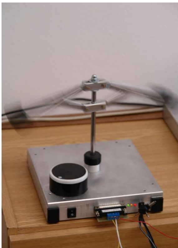
Obr. 5. Model Wattova regulátoru. Zdroj: Ústav informatiky AV ČR
