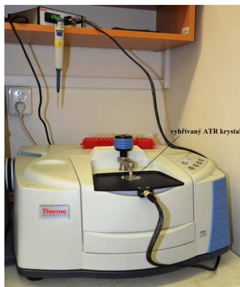
Obr. 17 FT-IR spektrometr Nicolet iZ10
