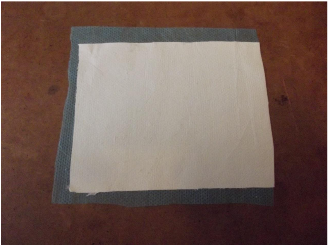
Obrázek č. 4: Zkoumaný scaffold PLA 16 \text{ g/cm}^2 na nosné modré tkanině
