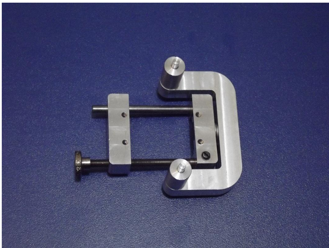
Obrázek č. 2: Vyrobený přístroj pro natahování scaffoldů v elektronovém mikroskopu
