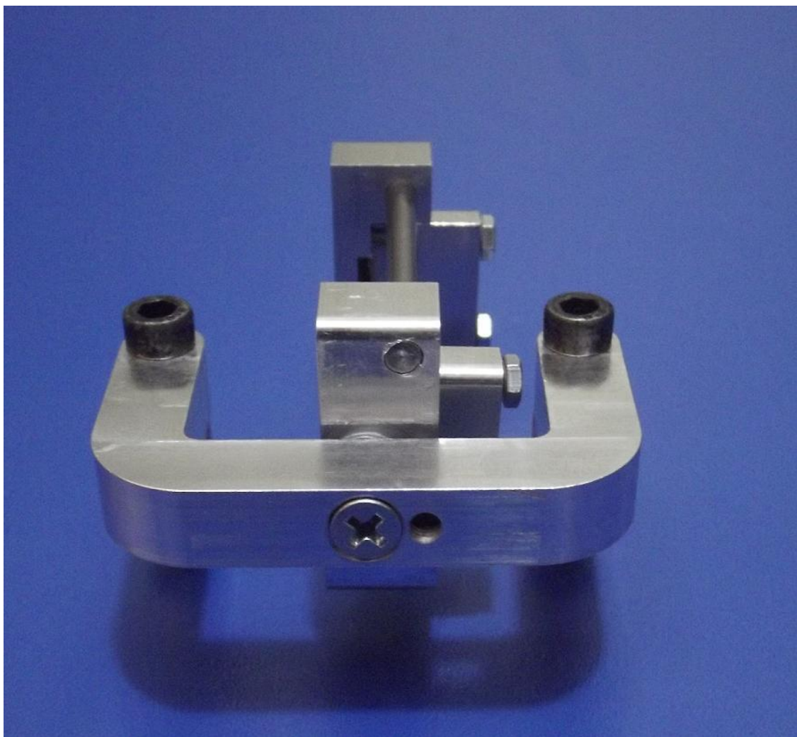
Obrázek č. 3: Vyrobenný přístroj pro natahování scaffoldů v elektronovém mikroskopu
