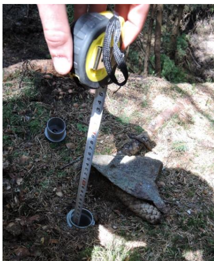
Obrázek 12: odečet polohy hladiny podzemní vody (HPV)
