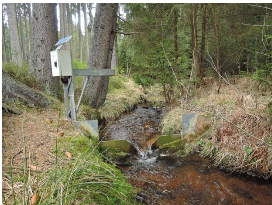
Obrázek 9: závěrový profil povodí TET s automatickým hladinoměrem
