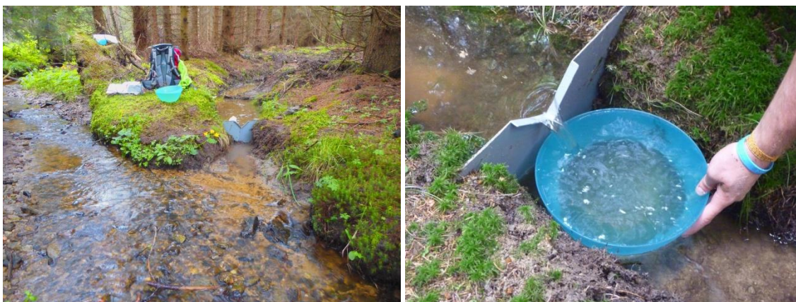
Obrázek 10a-b: ukázka umístění měrného profilu a přímého měření průtoku
