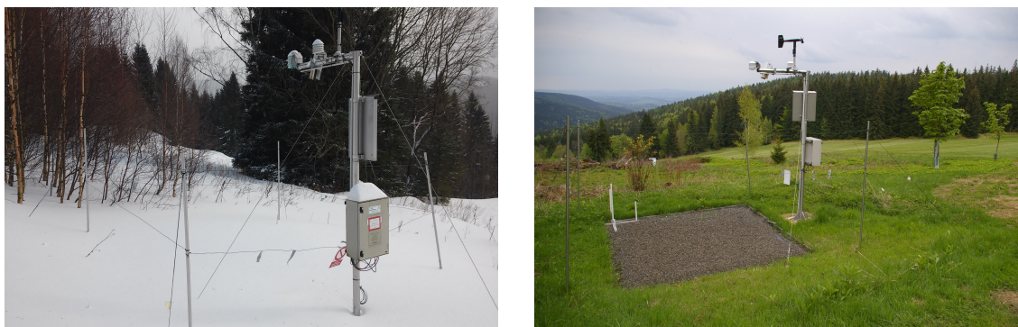
Obr. 7: Automatizovaná meteorologická stanice Hanapetrova paseka
