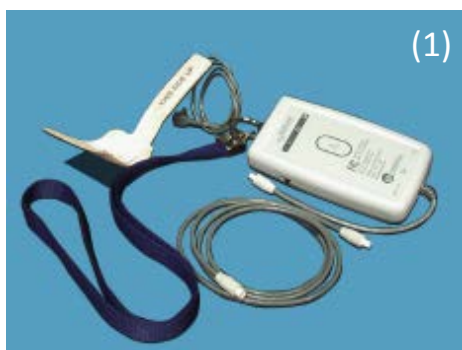
Pacientský set WalkAide® obsahující manžetu, stimulátor a elektrody (na obrázku hydrogelové)
