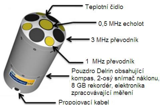
Obr. 2.3: Části typu M9 ADP (SonTek, 2010 – upraveno)
