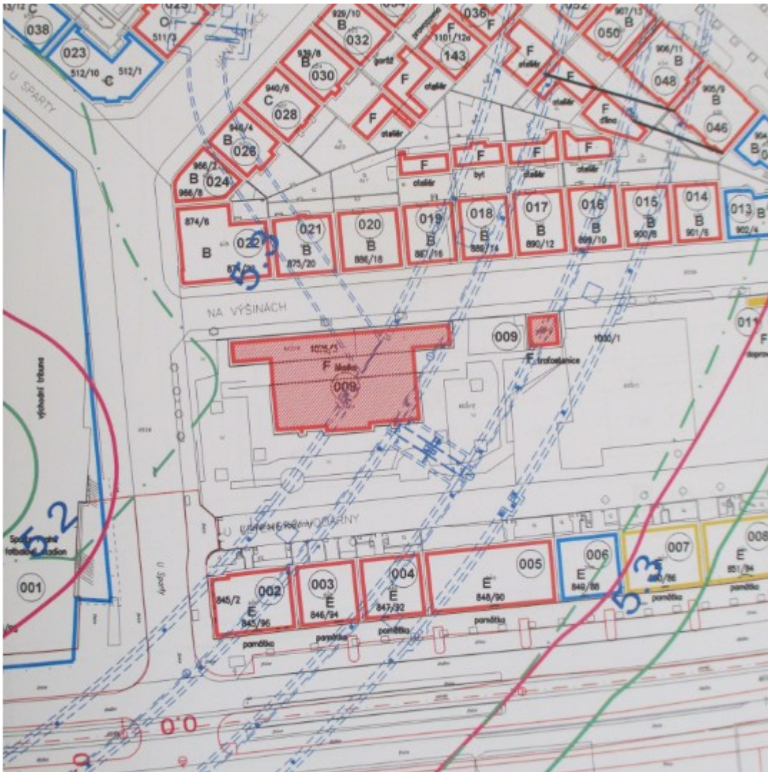
Obr 4: Rozmístění ražených děl pod objekty v ulicích Milady Horákové/Na Výšinách. Červeně vyplněný objekt je sledovaný objekt 3/1075. Červeně orámované objekty byly ovlivněny ražbou, modře orámované objekty byly ovlivněny částečně a žlutě orámované objekty byly sledovány bez zjištěných deformací. (Zdroj: Satra s.r.o.)
