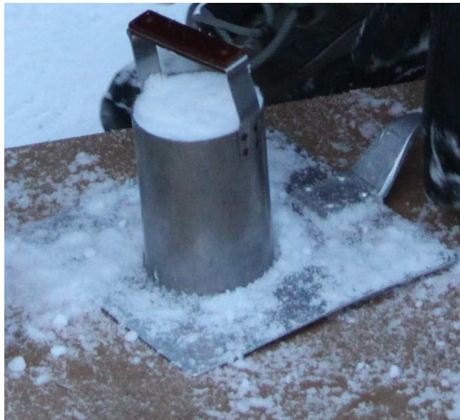
Obrázek 13 Měření měrné hmotnosti sněhu (foto L. Sieger)
