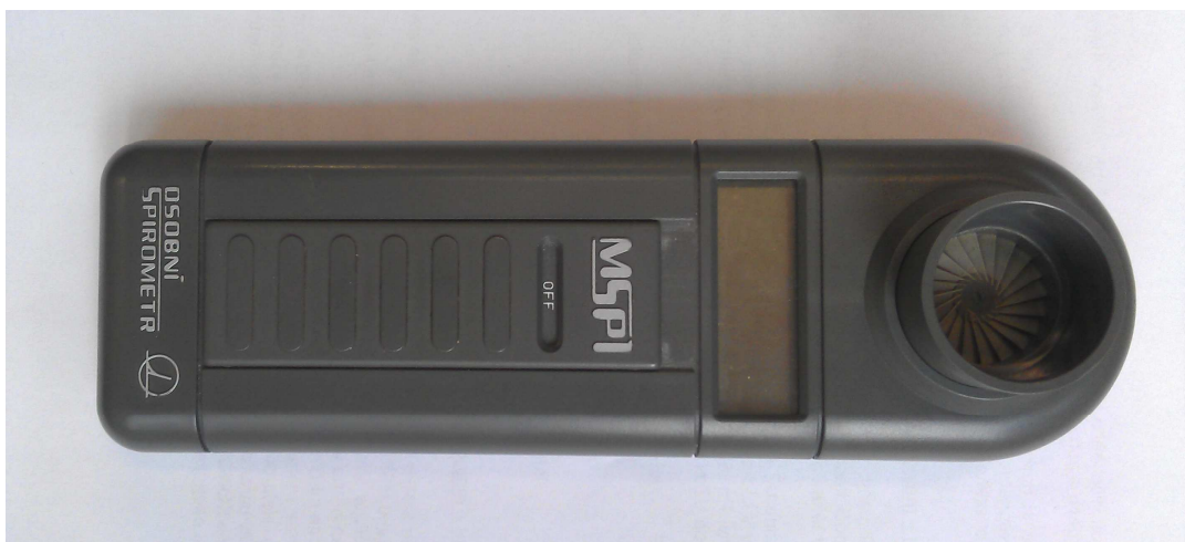
Obrázek 12 Spirometrický měřicí přístroj MSP1 (foto L. Sieger)
