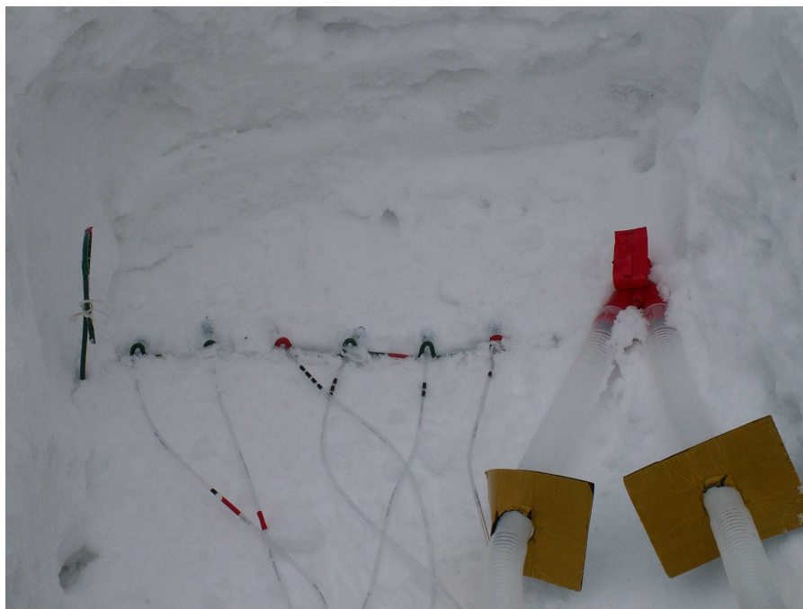
Obrázek 20 Příprava senzorů pro měření koncentrace CO 2 po ukončení experimentu fáze NP
