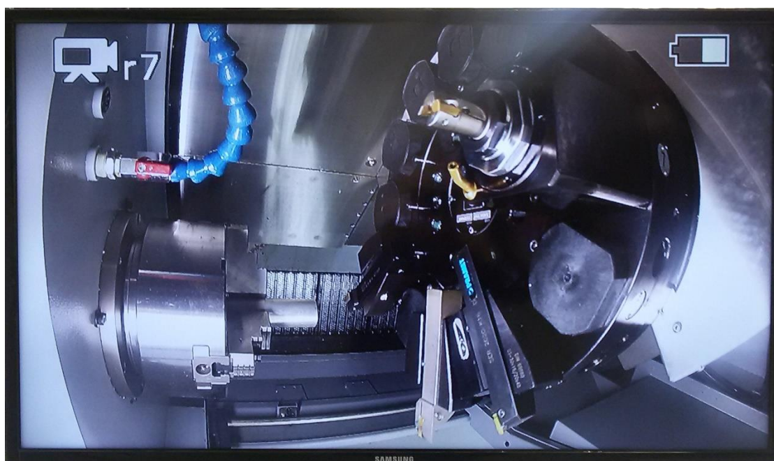
Obrázek 10: Náhled výstupu obrazu kamery z pracovního prostoru CNC stroje na TV.
