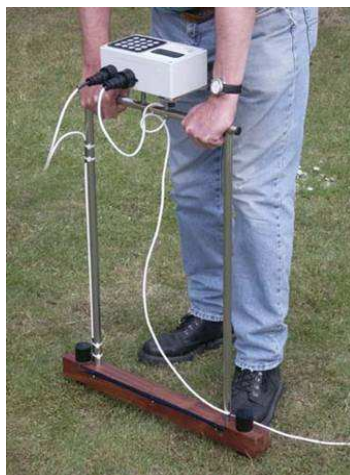
Obr. 5: Odporové měření: přístroj typu TR/CIA – podle Cambridge Archaeology Field Group 2012.
