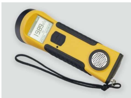
Obr. 73: Vlevo: kapametr typu Terraplus KT-10 – podle
