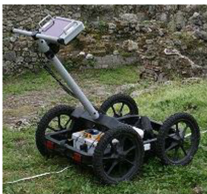
Obr. 14: Georadarový systém namontovaný na speciálním čtyřkolovém vozíku – podle Cambridge Archaeology Field Group 2012.
