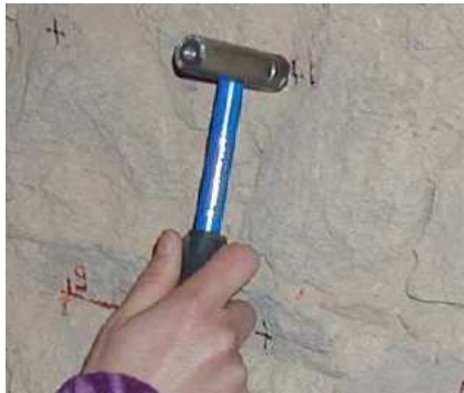
Obr. 35: Akustické měření. Vlevo: zdroj vlnění = úder kladívkem, vpravo: snímač – podle On-site investigation 2005.
