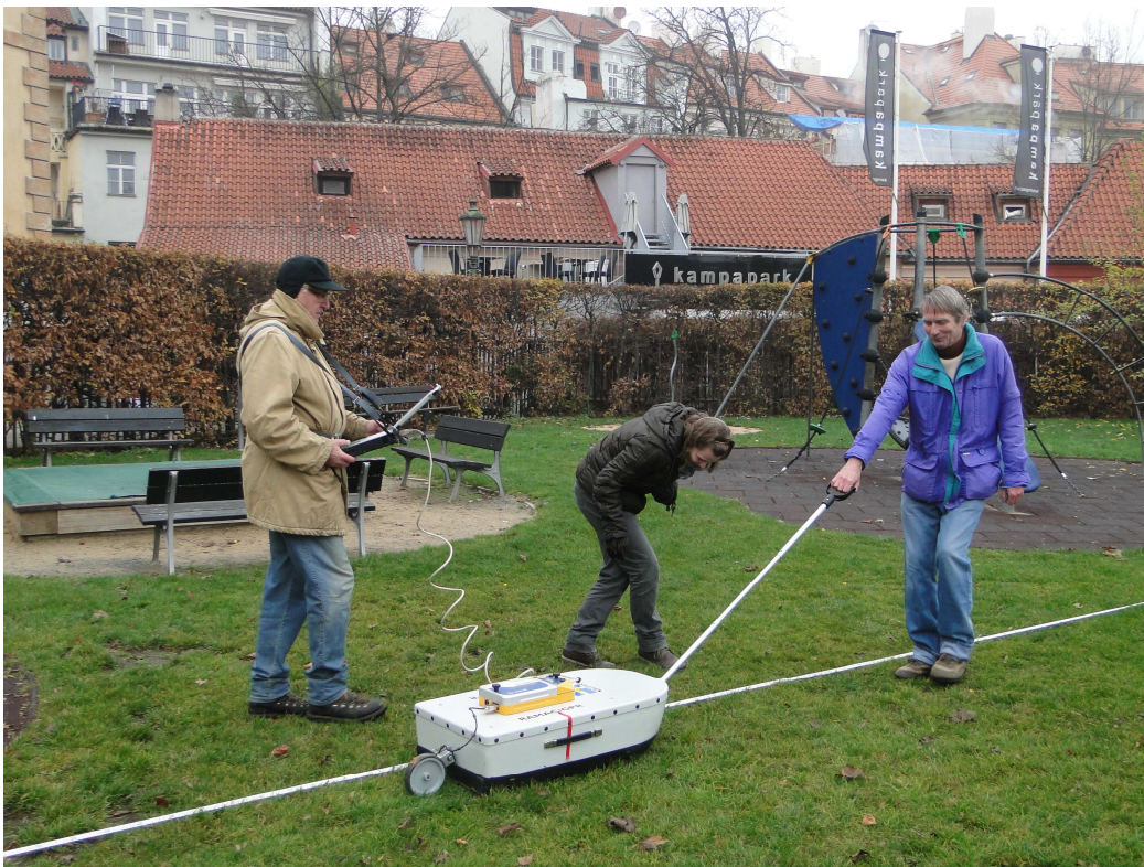
Foto 4: Georadarová metoda – profil 1 (Z. Jáně)
