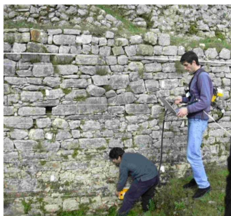
Obr. 61: Vlevo: měření georadarem na zdivu v exteriéru (Conimbriga, Portugalsko) – podle Catarino 2012, vpravo: měření georadarem (500 MHz) na severní zdi „Landgrafenzimmer“ na hradě Wartburgu – podle Hennen – Maierhofer 2005.
