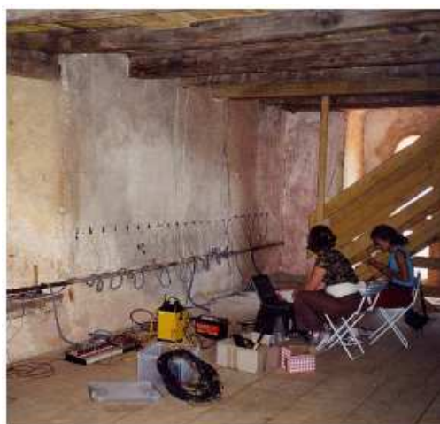
Obr. 52: Mikroseismické profilování, vlevo: uspořádání snímačů podél profilu, vpravo: hodochrona a stanovené rychlosti „v“ seismických vln ve dvou úsecích – podle On-site investigation 2005.
