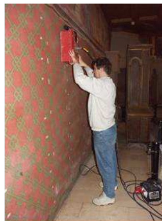
Obr. 61: Vlevo: měření georadarem na zdivu v exteriéru (Conimbriga, Portugalsko) – podle Catarino 2012, vpravo: měření georadarem (500 MHz) na severní zdi „Landgrafenzimmer“ na hradě Wartburgu – podle Hennen – Maierhofer 2005.
