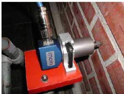
Obr. 30: Měření akustickou metodou „úder – odraz“ – podle On-site investigation 2005.
