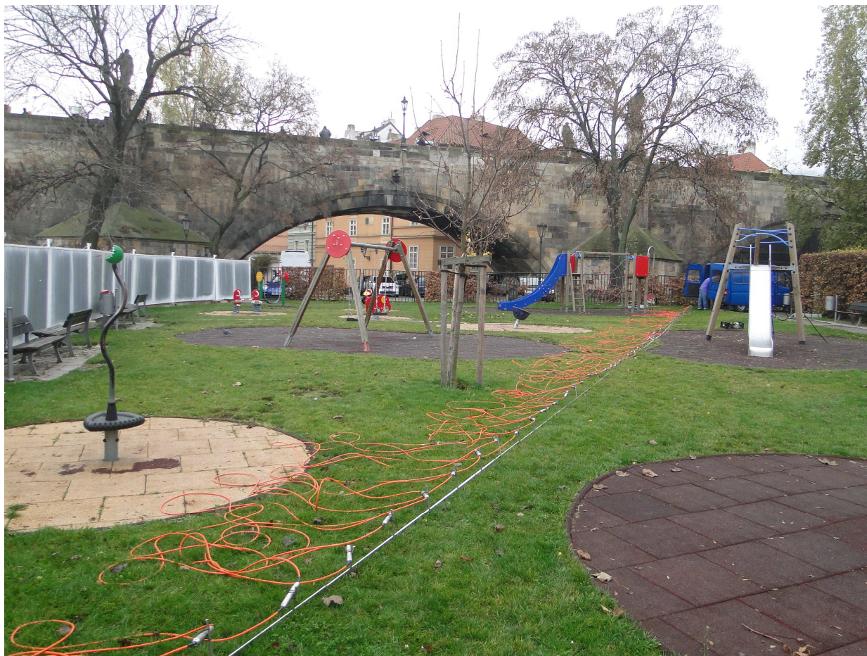
Foto 1: Lokalita Na Kampě (p. č. 744/1): Multielektrodové odporové měření - profil 1 (Z. Jáně)
