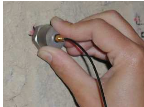
Obr. 35: Akustické měření. Vlevo: zdroj vlnění = úder kladívkem, vpravo: snímač – podle On-site investigation 2005.
