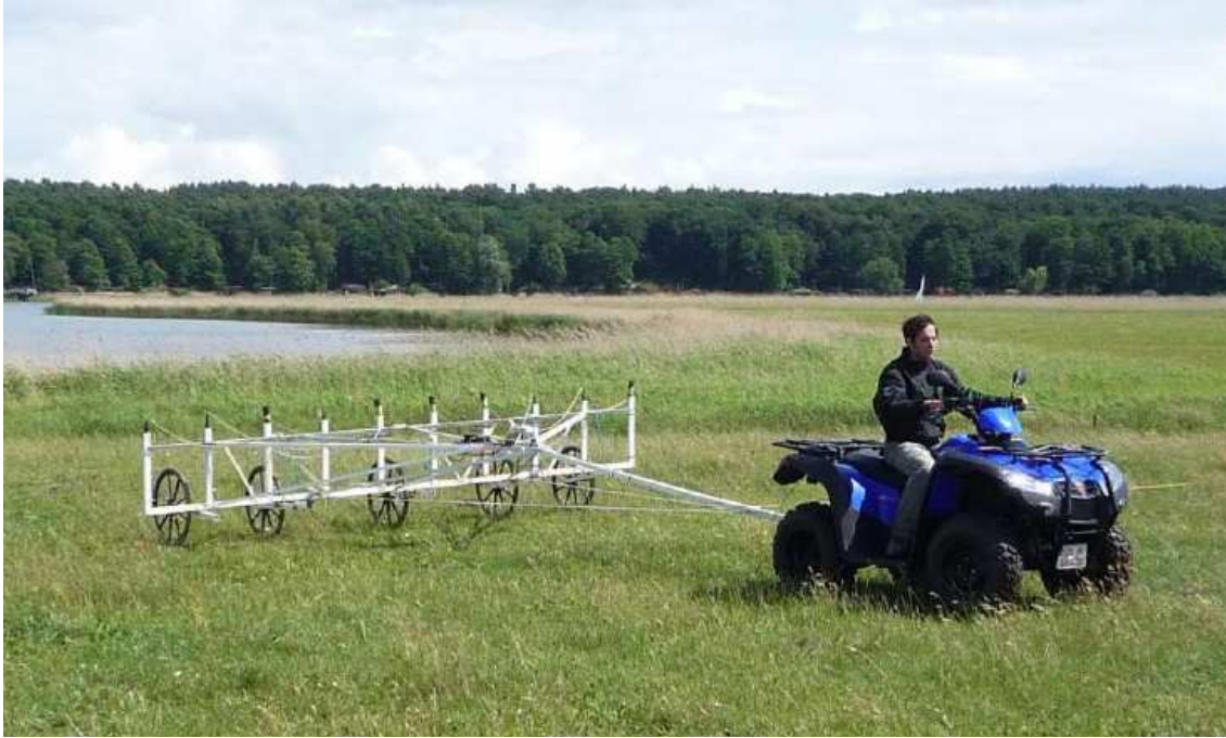
Obr. 19: Sestava deseti gradientometrů vytvořená společností Eastern Atlas pro velkoplošné průzkumy – podle Sala et al. 2012.
