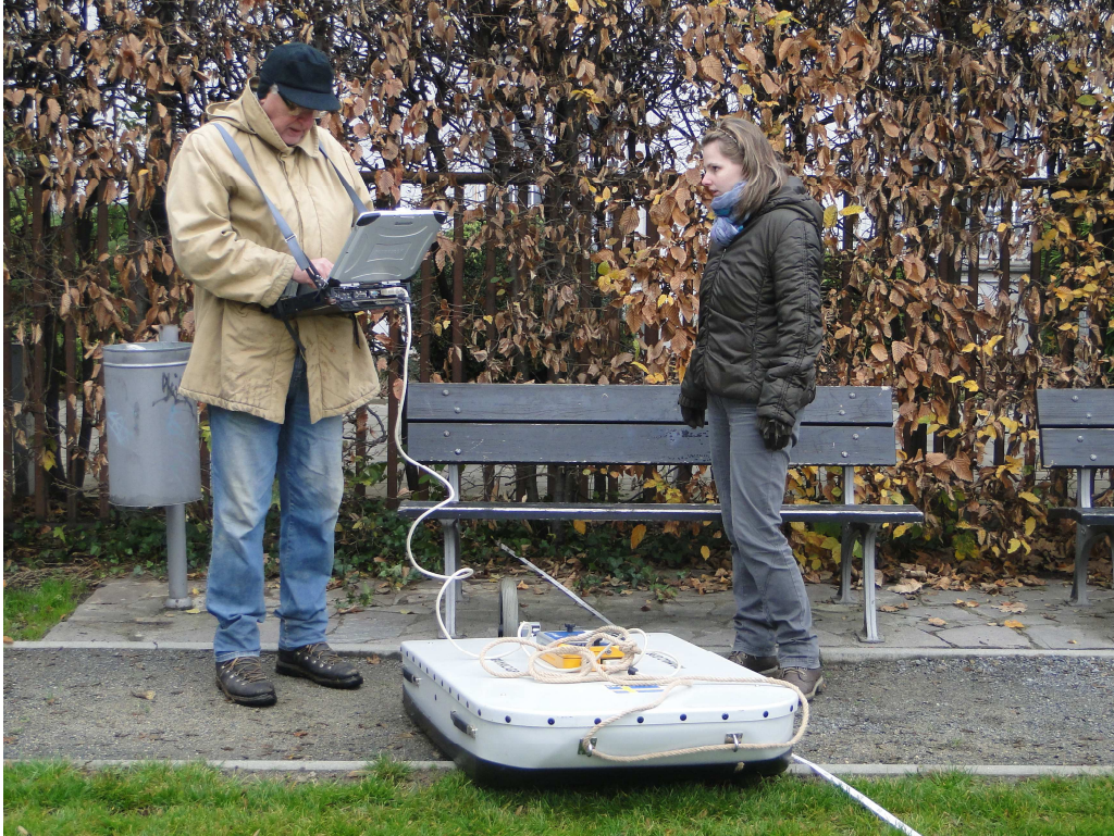
Foto 3: Georadarová metoda – profil 2 (Z. Jáně)
