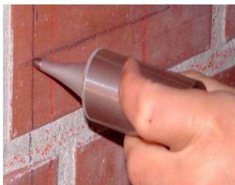
Obr. 46: Generátor ultrazvukového vlnění – podle On-site investigation 2005.
