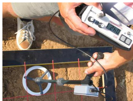
Obr. 73: Vlevo: kapametr typu Terraplus KT-10 – podle
