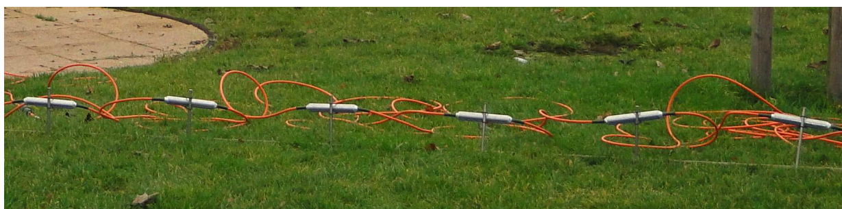
Foto 2: Multielektrodové odporové měření – detail zapojení elektrod (Z. Jáně)
