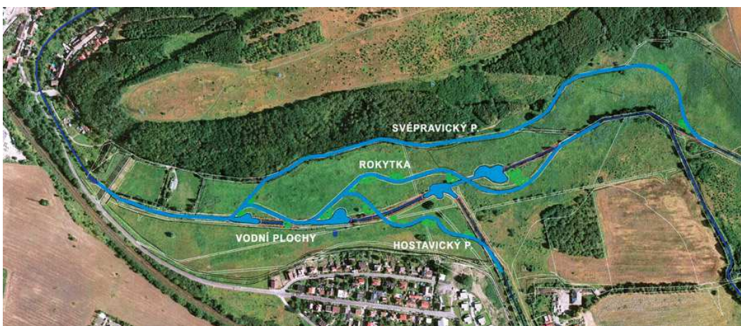
Obr. 13 Zákres změny trasy toků v revitalizovaném úseku suchého poldru Čihadla Měřítko přibližně 1:10000 Zdroj: Lesy HMP (2014)
