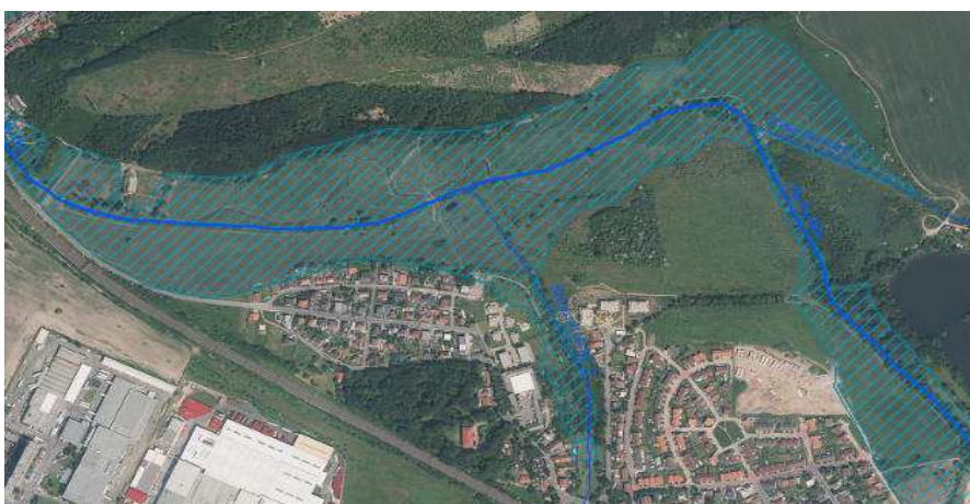
Obr. 14 Rozliv 100leté vody v suchém poldru Čihadla Vpravo patrná struktura vznikající zástavby. Měřítko přibližně 1:10000 Zdroj: DIBAVOD, WMS ČUZK (snímkování z roku 2013)
