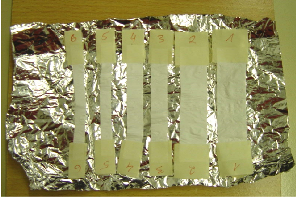
Fotografie č. 4 - Podlepené scaffolds lepicí páskou
