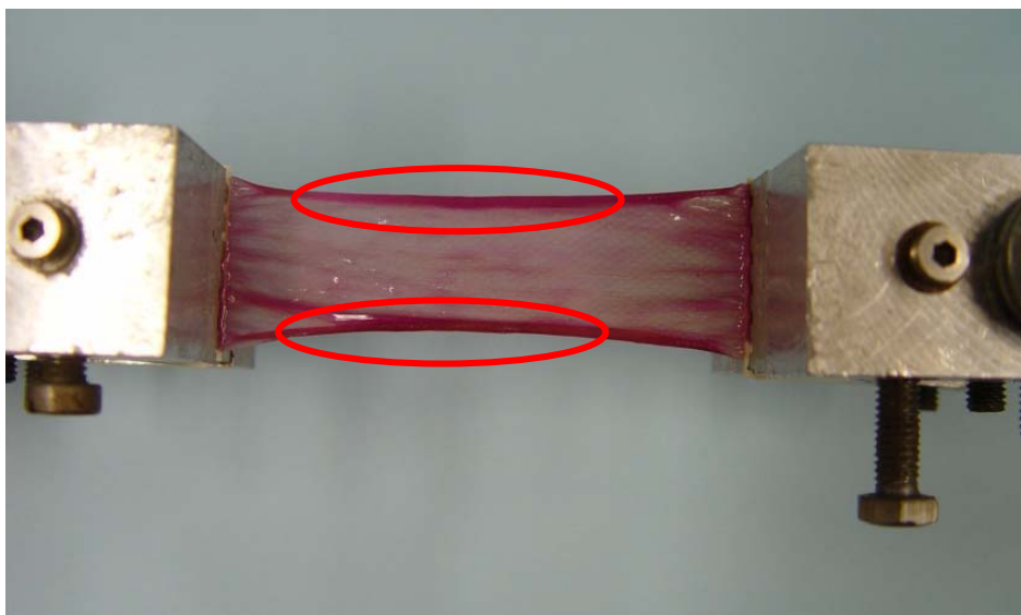
Fotografie č. 7 - Nevyhovující metodika hydratovaného vzorku scaffoldu
