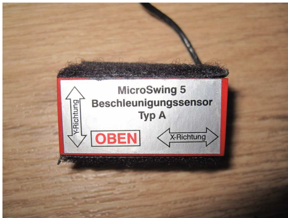
Obrázek 9: Akcelerometr typu A se znázorněnými kolnými osami X a Y (Archiv autora)
