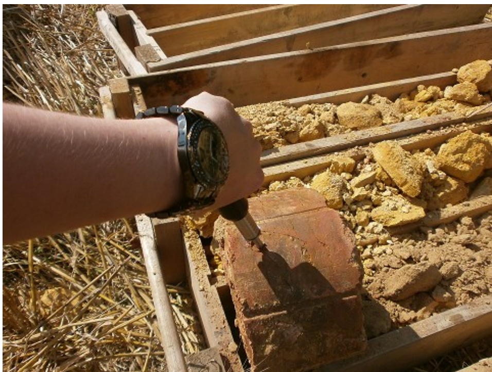
Obr. 2. Měření kapesním penetremetrem
