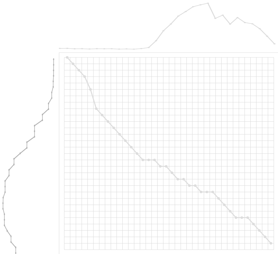
Obrázek 10: Grafická ilustrace průběhu algoritmu DTW. Matice lokálních vzdáleností s optimální cestou, vlevo průběh zaznamenané posloupnosti, nahoře průběh referenční posloupnosti.
