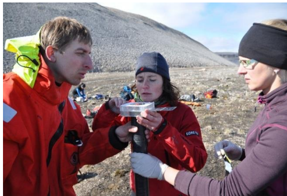
Obr. 38: Postup vzorkování profilu. Vzorky byly řezány po 1 cm a vkládány do neprůsvitných plastových pytlíků. Aby se nekontaminovaly kovovými prvky, byl vyfocení vzorkovač později vyměněn za plastovou destičku a škrabku.
