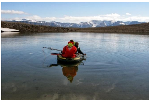
Obr. 37: Byly provedeny 3 úspěšné odběry z nejhlubší části jezera (cca 5 m), kam se dopravovalo pomocí nafukovacího člunu. Foto Daniel Vondrák
