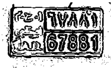
Obrázek 3.5: Sloučení binárních obrázků vertikálních a horizontálních hran
