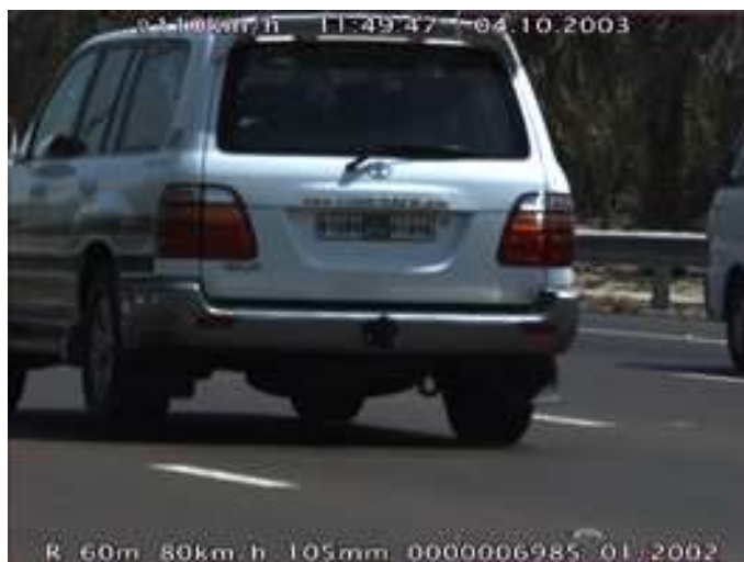
Obrázek 2.8: Vydařená fotografie vozidla doplněná o informační proužek (nahore a dole) — původně v rozlišení 1392 \times 1030 \times 48
