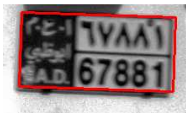
Obrázek 3.6: Lokalizace SPZ pomocí projekcí a zmenšování kandidátního obdélníku — nalezená oblast SPZ je na obrázku zvýrazněna červeně
