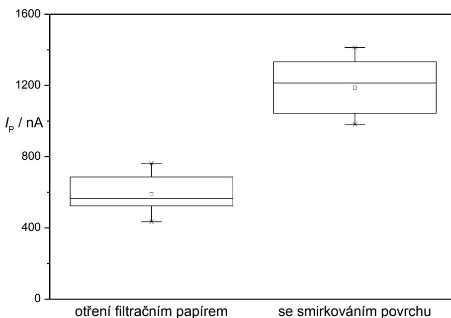
Obr. 3.11 Krabicové grafy výšek píků 4-nitrofenolu o koncentraci 5 \cdot 10^{-5} \text{ mol} \cdot \text{dm}^{-3} v prostředí BR pufru o pH 10, naměřené na elektrodách s různou úpravou podkladového materiálu, spočtené z deseti měření. Podmínky DPV: rychlost polarizace 20 \text{ mV} \cdot \text{s}^{-1} , výška pulzu 50 mV, šířka pulzu 100 ms.
