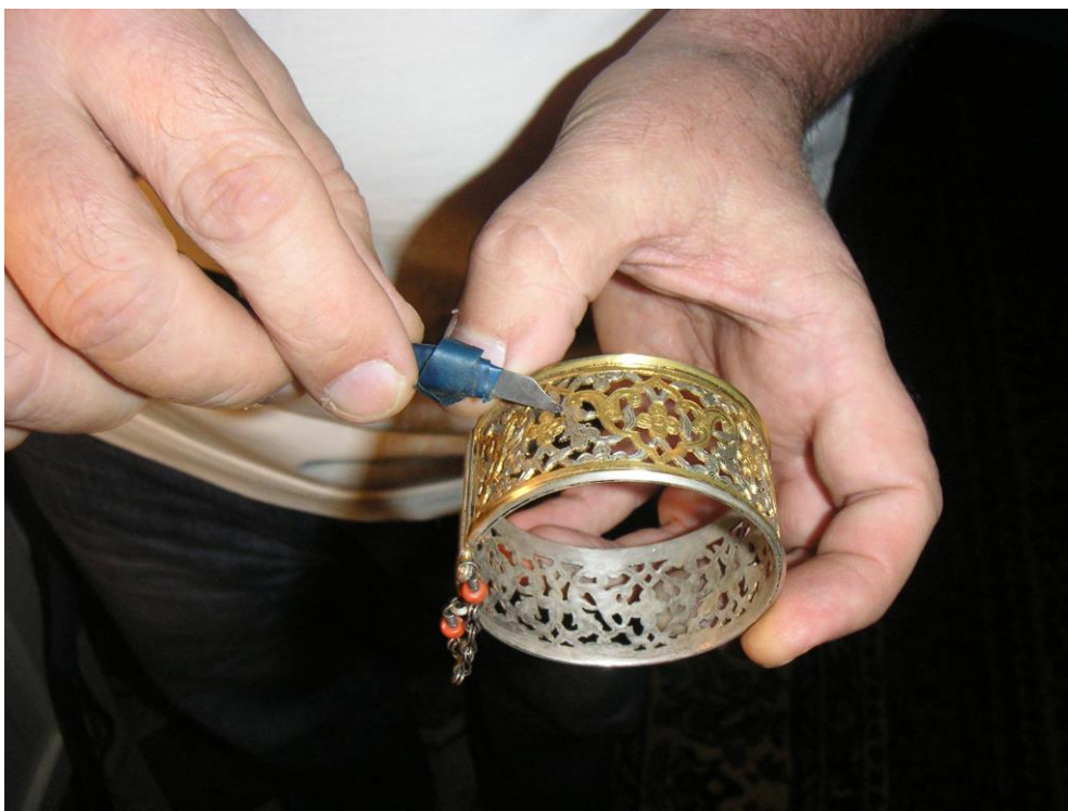
Ukázka vytváření prolamovaného vzoru. Dílna tádžického šperkaře, Buchara, 2012.
