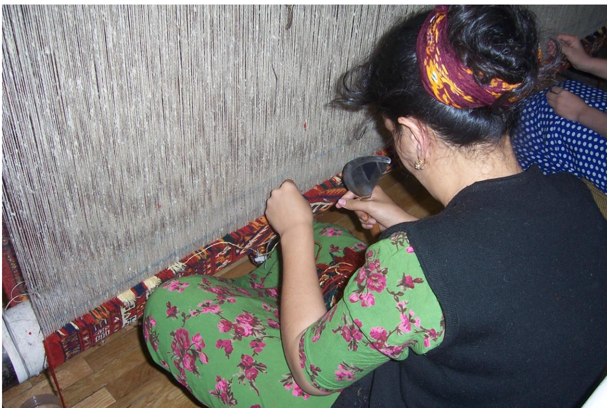
Vázání koberce na vertikálním stavu. Turkmenistán, Ašchabad, 2012.
