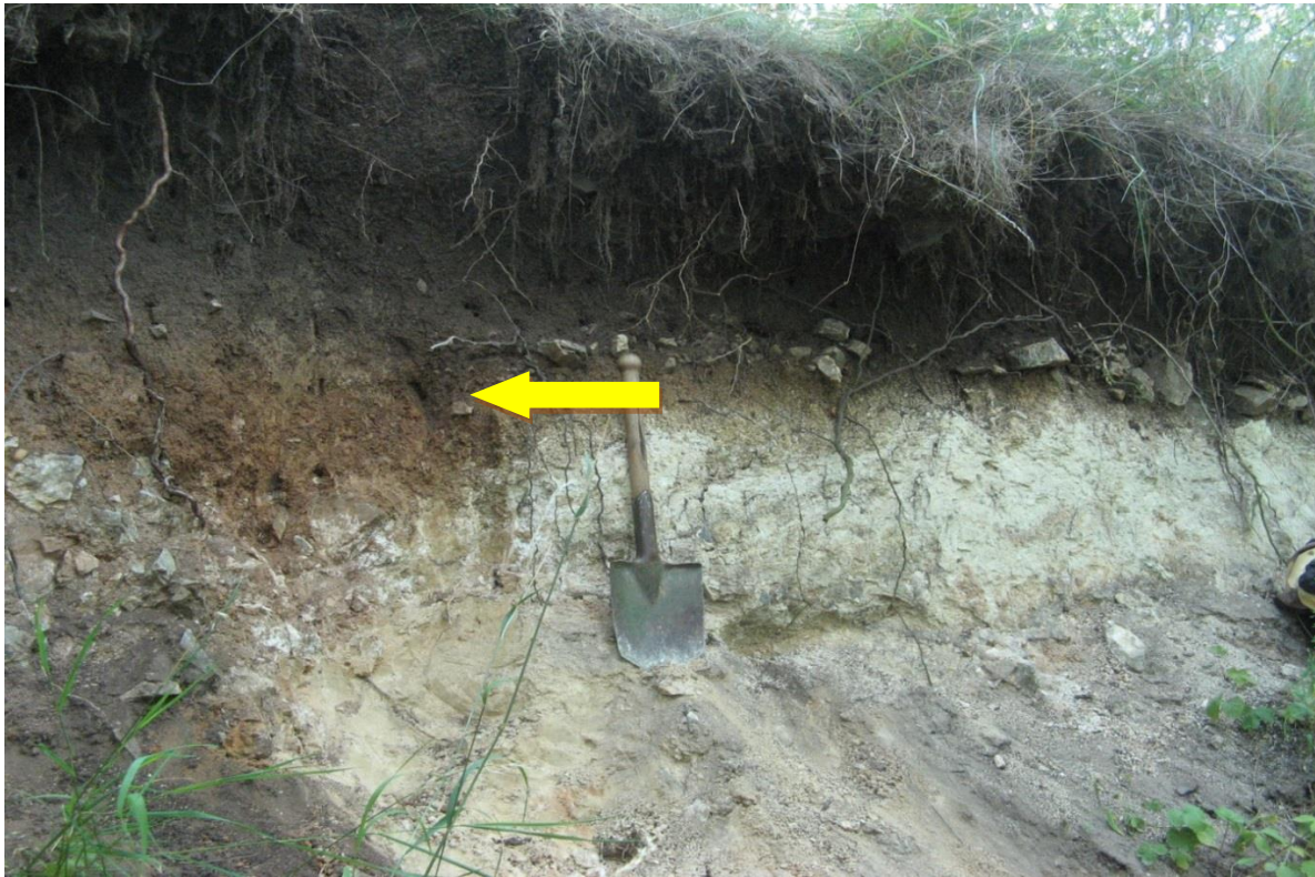
Figure 1.8. Chernozem calcique (Kuchyňka, Rép. Tchèque) ; l'horizon chernique Ac est caractérisé par sa teneur élevée en matières organiques (couleur noire) et une densité racinaire élevée. L'horizon calcique est représenté par le niveau brun enrichi en calcaire (flèche). La roche mère est constituée de sédiments loessiques carbonatés. Photo : B. Vysloužilová.
