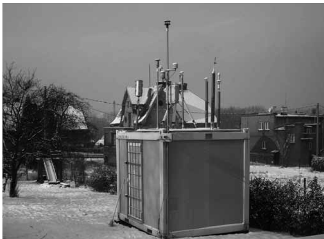
Obr. 1a: Pohled od východu na stanici v lokalitě Ostrava-Radvanice v lednu 2012. Kaskádní impaktor je objemný ocelový válec vlevo nahoře na střeše stanice
