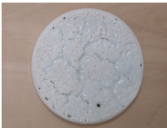
Obr. 69: Struktura kynutého porcelánu s glazurou
