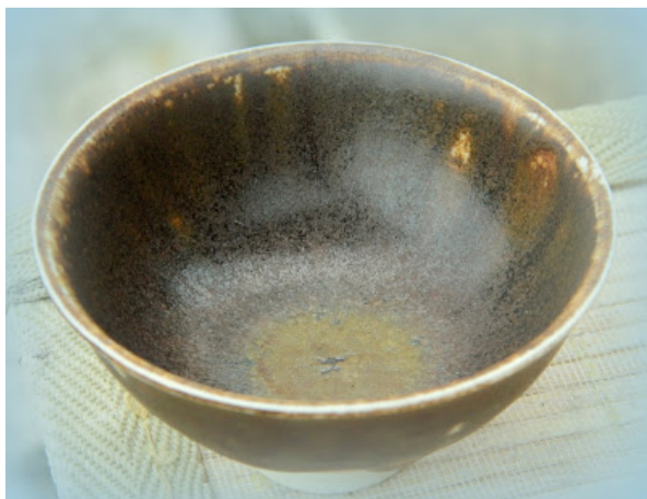
Obr. 59: Glazura vytvořená z ořechových skořápek
