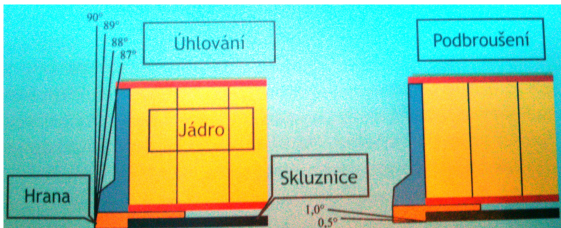
Obrázek 42 Schematické znázornění úhlování hrany a její podbroušení
