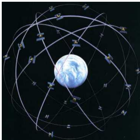
Obrázek 1: Kosmický segment globálního navigačního systému GPS NAVSTAR
