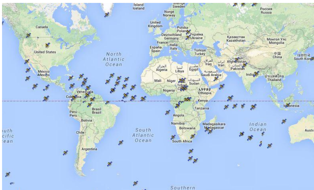
Obrázek 6: Reálné pozice navigačních satelitů systému GPS NAVSTAR
