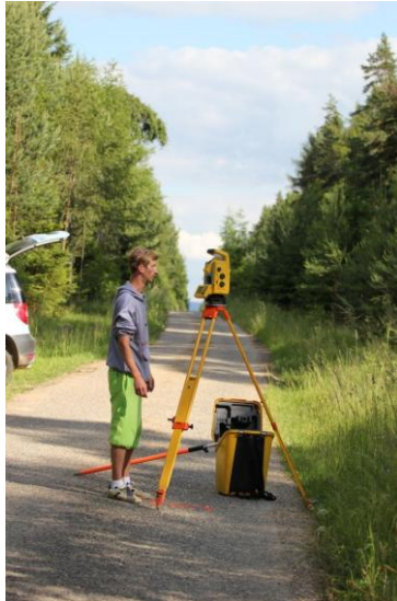
Obrázek 25: Zaměřování přímočarého testu Trimble S3
