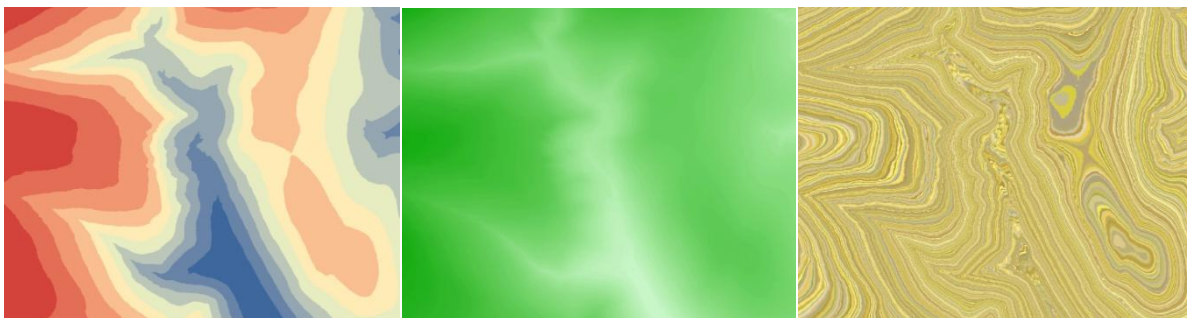
Obr. 17: Barevná hypsometrie při použití odlišných funkcí v programu ArcGIS. Barevná hypsometrie vytvořená klasifikací do 10 tříd (vlevo), roztažením barevné škály (uprostřed), použitím diskrétních barev (255 barev). Zdroj dat: DMR 5G (2013).
