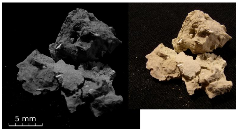
Obr. 4 Bílé vyrostlice bassanitu ve vzorku číslo F30V (FEBEX, 80–90 °C, 12 měsíců). Gama parametr obrázku vlevo byl z důvodu zvýraznění zrn upraven na hodnotu 0,45. Obrázek vpravo je v reálných barvách.
