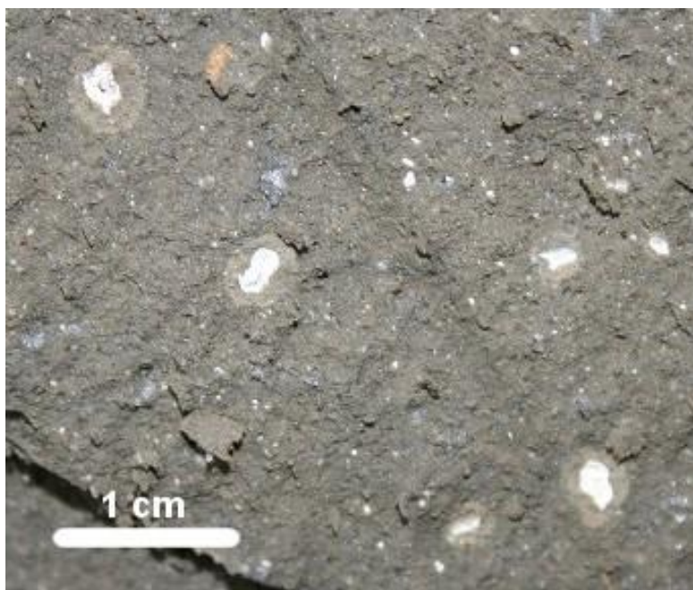
Obr. 26. Detail sádrovcových zrn s illitovou aureolou v zásypu experimentální nádoby. Zdroj: CEG.
