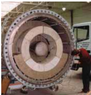
Obr. 42. Prstenec betonových tvárnic, které v jednom místě experimentální nádoby nahradily běžné tvárnice těsnící bariéry. Zdroj: (EURIDICE 2006).
