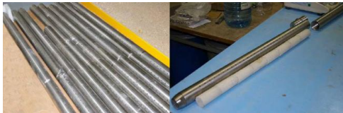
Obr. 24. Patrony do jádrových vrtů (vlevo), patrona P1 připravena k naplnění materiálem FEBEX (vpravo). Zdroj: CEG.
