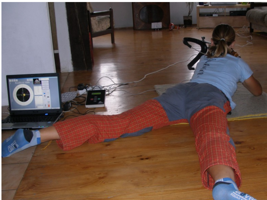
Obrázek č. 8: Střelecký trenažer se skládá z čidla upevněného na hlavní zbraň, spojeného s
