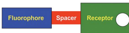
Obrázek 5: Struktura PET senzoru (převzato z De SILVA, A. Prasanna, MOODY, Thomas S., WRIGHT, Glenn D. Fluorescent PET (Photoinduced Electron Transfer) sensors as potent analytical tools. Analyst . 2009, roč. 134, č. 12, s. 2385 – 2393.)
