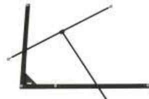
Obr. 11 Kalibrační hůlka ve tvaru T a referenční struktura ve tvaru písmene L - URL2
