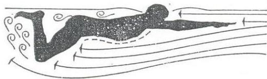
Tři druhy odporu vody (šipkami vyznačen čelný odpor, čárkovane povrchové tření, spirálkami vířivý odpor).
