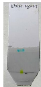
Obr. 84 - TLC destička pro mobilní fázi - směs denaturovaného ethanolu a destilované vody v poměru 1:5
