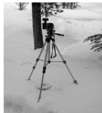
Obrázek 14: Ilustrace sestavení zařízení při pořizování hemisférických snímků. (Hardy et al., 2004)
